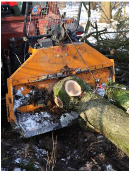
Das 1,80 m breite Rückeschild ist sehr stabil und auch 2 oder 2,20 m breit lieferbar. Nur die in der praktischen Choker-Leiste integrierte Kupplung kann schon mal verbiegen. Alternativ gibt es das Schild mit glatter Rückwand und Einsteck-Kupplung.
