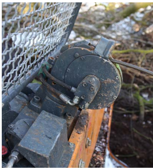
Der hydraulische Seilausstoß ist eine große Arbeitserleichterung, kostet aber 2 400 Euro extra. Die maximale Auswurfgeschwindigkeit (kleines Bild) wurde bereits von 1 auf 2 m/s erhöht und ist zukünftig sogar per Funk einstellbar.
