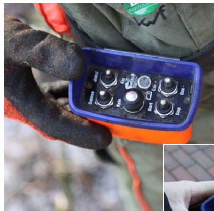
Die HBC-Funkfernsteuerung FST 508 patrol S (oben) ist gut zu bedienen und wird mit zwei Akkus samt Ladegerät geliefert. Wen das Lösen der Bandbremse unter Last per Stotterbremse (z.B. bei der Gefahrbaumfällung) nicht zufriedenstellt, der kann mit der FST 511 (rechts) ein proportionales Lastsenkventil per Funk ansteuern.
