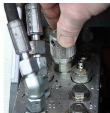
Der hydraulische Seilausstoß ist eine große Arbeitserleichterung, kostet aber 2 400 Euro extra. Die maximale Auswurfgeschwindigkeit (kleines Bild) wurde bereits von 1 auf 2 m/s erhöht und ist zukünftig sogar per Funk einstellbar.
