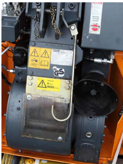
Von dem seitlich versetzten Zapfwellenstummel geht es über eine Duplexkette nach unten zum Schneckengetriebe mit Lamellenkupplung. Auf der anderen Seite der Seiltrommel liegt die Bandbremse.
