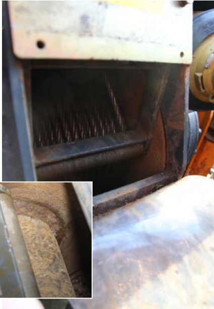
Der Arbeitsdruck der Kupplung wird über eine (versteckte) Winkelmessung im Zulauf gesteuert. Deshalb ist die Zugkraft tatsächlich auf der oberen Seillage noch fast genauso groß, wie auf der unteren. Das Seil wird per Inbus-Schraube auf der Trommel gesichert (kleines Bild).
