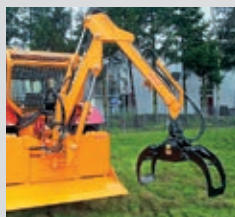
Schnellwechselvariante auf Rückeschild
