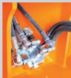
Wegeventile elektrisch umschaltbar
