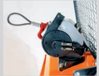
Seilauswurf in Kombination mit Seileinlaufbremse (Option)
