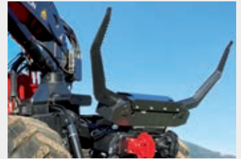
Klemmbank hydr. wegklappbar
