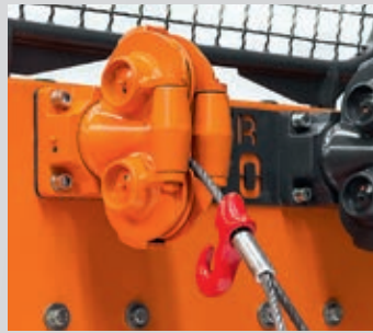
Doppelrolle mit seitlichen Führungsrollen
