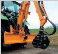
Aufbau an Rasterschiene mit Rückeschild
