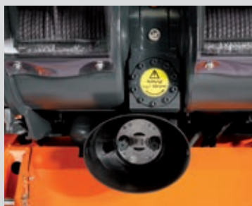
DUO Zapfwelle für Front- und Heckanbau (Option)
