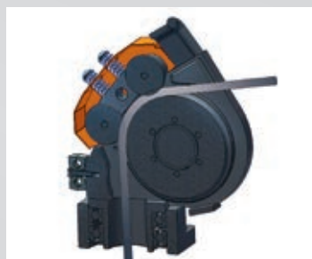
Seilauswurf mit zwei integrierten Andruckrollen
